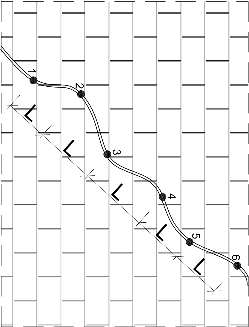
L - distanta dintre stuturi de injectare Injectarea fisurilor in ordinea numerotarii (de jos in sus) 1...5.
